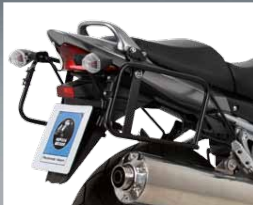
LOCK IT System Seitenträger, abnehmbar - für alle Hepco & Becker Seitenkoffer
